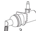
Wenn der Spender die Flüssigkeit / Seife nicht normal abgibt, überprüfen Sie bitte, ob die Kartusche leer ist oder nicht. Wenn ja, füllen Sie sie bitte auf oder ersetzen Sie diese durch eine neue Kartusche. Wenn das Problem weiterhin besteht, ersetzen Sie es bitte durch ein neues Pumpenset.
